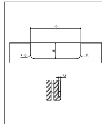
Effettuare la fresatura o manualmente con dima SFS intec o con CNC.
