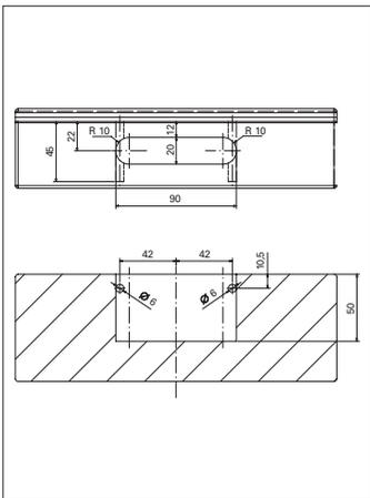
Effettuare la fresatura o manualmente con dima SFS intec o con CNC.
