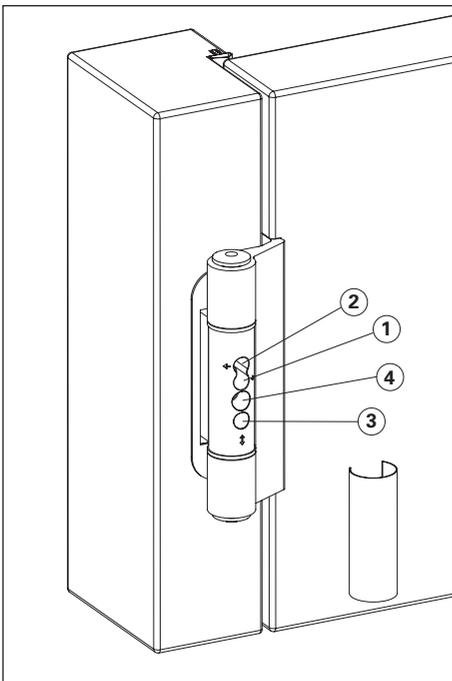
Il sistema Easy 3D per portoncini in legno, permette 3 regolazioni (laterale, in altezza e in profondità) agendo direttamente sul corpo centrale della cerniera. La stessa cerniera può essere applicata su portoncini sia destri che sinistri.
