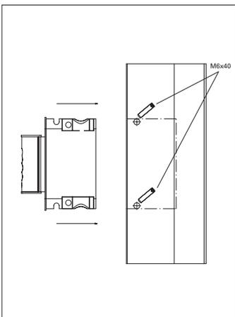
Inserire la tasca nella fresatura con la stampigliatura "**SFS**" rivolta verso l'alto e fissarla nel telaio con le viti in dotazione M6x40.
