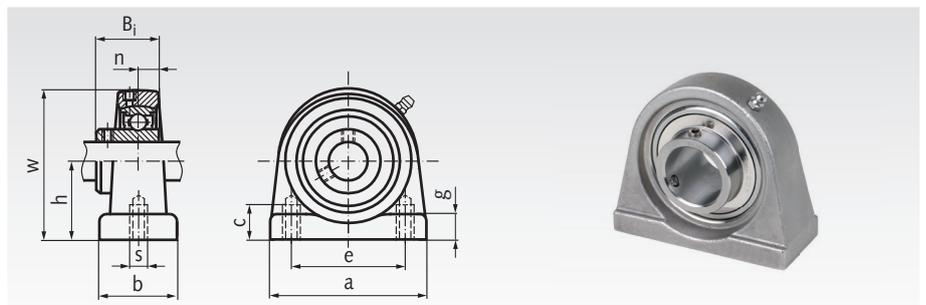
Bestellangaben: z.B.: Art.-Nr. 625 993 12, Kugel-Stehlager SSUCPA 201, Bohrung 12mm
