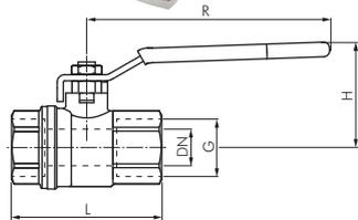
**Werkstoffe:** Gehäuse: Messing vernickelt, Kugel: Messing hartverchromt, Dichtung: PTFE, Hebel: Stahl verzinkt, silikonfrei gefertigt
