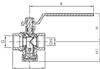
**Werkstoffe:** Gehäuse: Messing vernickelt, Kugel: Messing verchromt, Dichtung: PTFE/FKM/NBR, Sieb: 1.4301/PA, Verschlusskappe: Messing vernickelt
