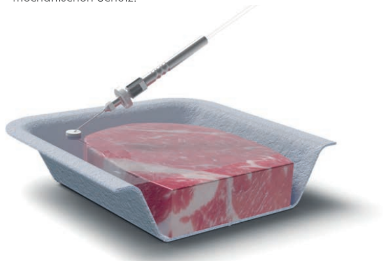
Entnahme einer Schutzgasgemisch-Probe aus einer Lebensmittelverpackung
