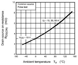
Fig. 8.9 R<sub>DS(ON)</sub> - T<sub>a</sub>
