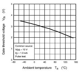
Fig. 8.8 V<sub>th</sub> - T<sub>a</sub>
