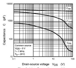
Fig. 8.11 Capacitance - V<sub>DS</sub>
