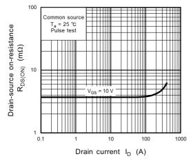
Fig. 8.5 R<sub>DS(ON)</sub> - I<sub>D</sub>
