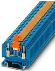
Messertrennklemme, mit Prüfbuchschrauben zur Aufnahme von Prüfsteckern, Nennspannung: 400 V, Nennstrom: 16 A, 1. Etage, Anschlussart: Schraubanschluss, Bemessungsquerschnitt: 2,5 mm<sup>2</sup>, Querschnitt: 0,2 mm<sup>2</sup> - 4 mm<sup>2</sup>, Montage: NS 35/7,5, NS 35/15, NS 32, Farbe: blau
