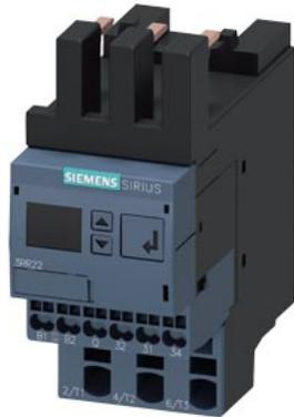
Überwachungsrelais, anbaubar an Schütz 3RT2, Baugröße S0 Standard, digital einstellbar Schein-/Wirkstromüberwachung 4...40 A, 20...400 Hz, 3-phasig Versorgung 24 V AC/DC 1 Wechsler, 1 Halbleiterausgang für Alarm und Warnung Überwachung auf Stromüber- und Unterschreitung Phasenausfall, Drahtbruch Phasenfolge Fehlerstrom Blockierstrom Warnung und Alarmschwellen mit oder ohne Fehlerspeicher Anlaufverzögerung 0-99 s Störspitzenausblendung 0-30 s Pause nach Fehler 0-300 min Federzugtechnik
