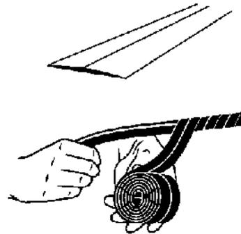
Die Benutzung ist einfach. Beim Verarbeiten des Bandes, (z.B. beim isolieren), wird durch die Trapezform eine gleichmässige Oberfläche erreicht.
