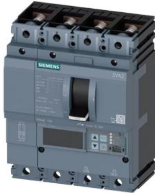
Leistungsschalter 3VA2 IEC Frame 100 Schaltvermögenklasse H Icu=85kA @ 415V 4-polig, Anlagenschutz ETU860, LSIG, In=100A Überlastschutz Ir=40A...100A Kurzschlusschutz Isd=0,6..10x In, li=1,5..12x In N-Leiterschutz einstellbar (OFF, bis 100%) Erdschlusschutz, abschaltbar Ig=0,2...1 x In= tg=0,05-0,8s Schraubenflachanschluss
