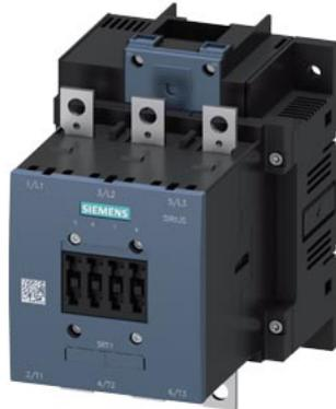
Leistungsschütz, AC-3 185 A, 90 kW / 400 V AC (50-60 Hz) / DC-Betätigung UC 220-240 V ohne Hilfskontakte 3-polig, Baugröße S6 Schienenanschlüsse Antrieb: konventionell
