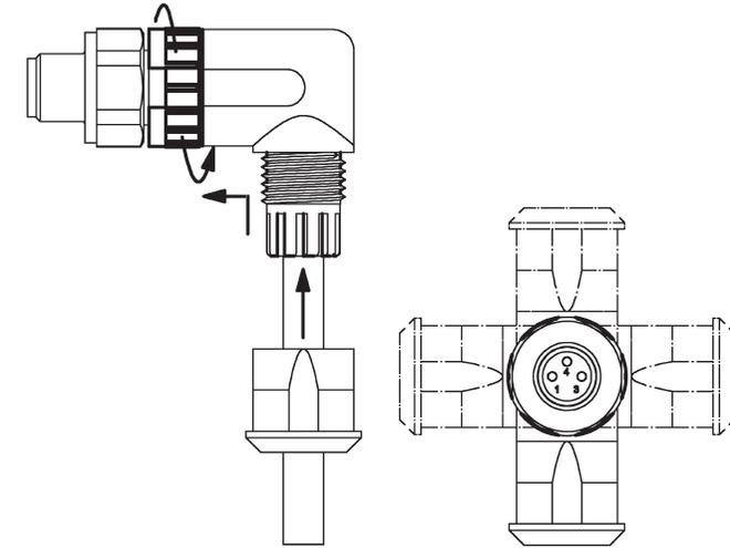
7. Verschrauben Sie die Überwurfmutter bis auf Anschlag.
