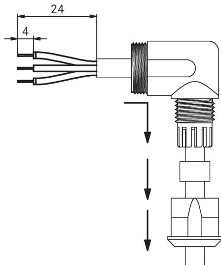
4. Führen Sie die Litzen nacheinander bis zum Anschlag in die vorgesehenen Kammern im Steckereinsatz ein und ziehen Sie die Schraube mit einem Innensechskantschlüssel 0,9 mm an. Das empfohlene Drehmoment ist 0,1 Nm.
