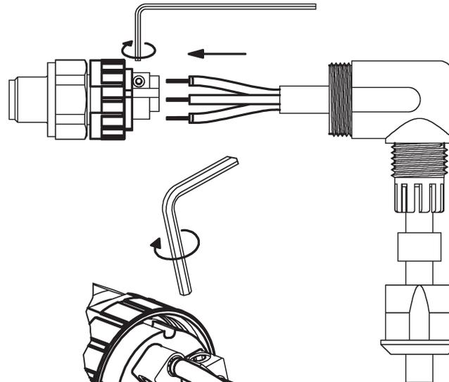
5. Verschrauben Sie das Gehäuse mit dem Steckereinsatz bis auf Anschlag. Das Gehäuse kann in vier verschiedenen Positionen in 90° Intervallen montiert werden.
