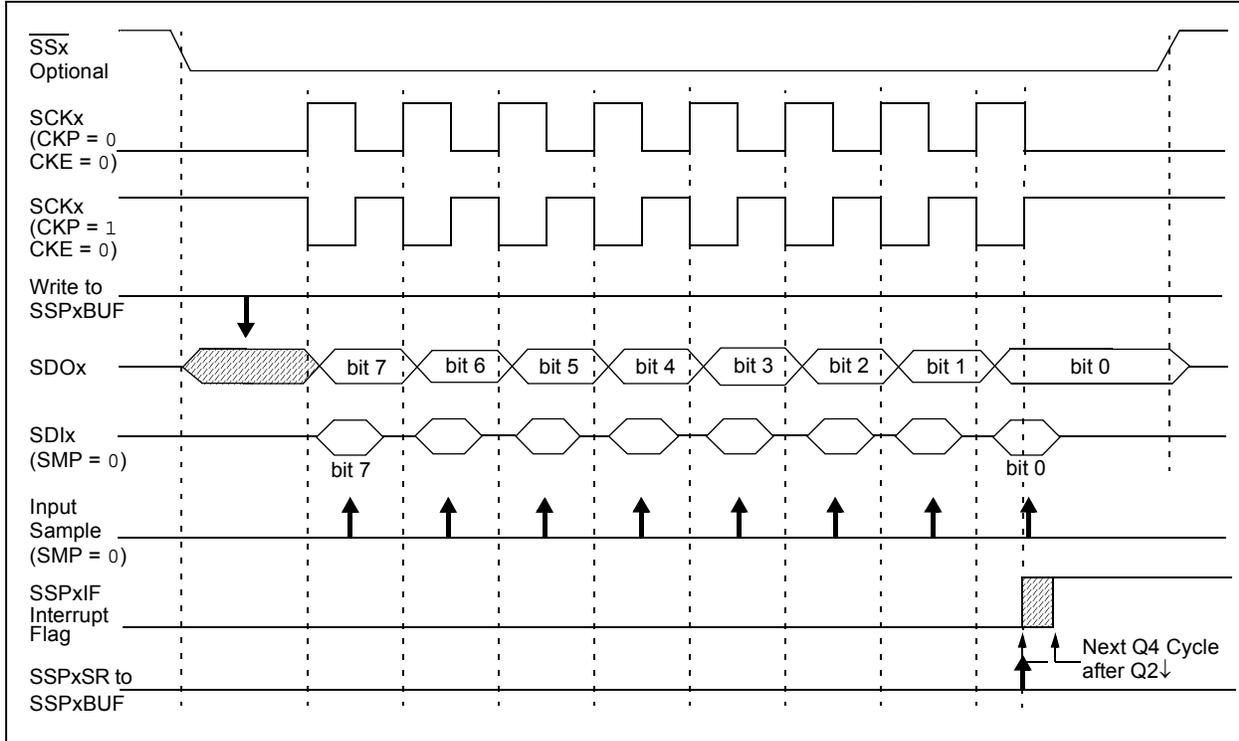
**FIGURE 21-6: SPI MODE WAVEFORM (SLAVE MODE WITH CKE = 1)**
