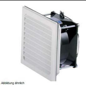
FILTERLUEFTER LUFTSTROM FREI 25 M3 PRO H AUSSCHNITT 92X92 MM 115 V AC RAL 7035 LEISTUNGSAUFNAHME 12W SCHUTZART IP 54 GUETEKLASSE 2
