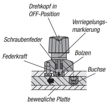
Der Bolzen fährt beim Loslassen des Kopfes in die MID-Position aus und drückt mit einer leichten Federkraft gegen die bewegliche Platte, die Schraubenfeder nimmt die Kraft im inneren des Körpers auf. Die Verriegelungsmarkierung (rot) ist sichtbar und die Platte lässt sich bewegen.
