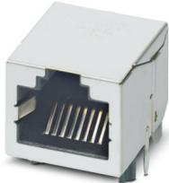
RJ45-Leiterplatten-Steckverbinder, Bauform: RJ45, Schutzart: IP20, Polzahl: 8, 10 GBit/s, Material: Metall, Anschlussart: THR-Reflow / THT-Welle, kurze Lötkontakte
