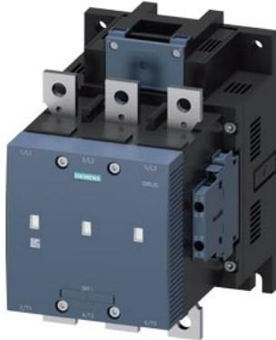
Vakuumschütz AC-3e/AC-3 225 A, 110 kW / 400 V, 3-polig, Uc: 380-420 V AC(50-60 Hz) / DC Antrieb: konventionell Hilfskontakte 2 S + 2 Ö Hauptstr.: Schiene Steuer- und Hilfsstromkreis: Schraubanschluss
