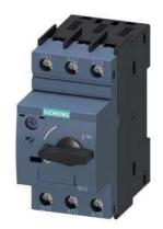
Leistungsschalter Baugröße S00 für den Trafoschutz A-Auslöser 0,35...0,5 A N-Auslöser 10 A Schraubanschluss Standardschaltvermögen
