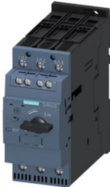
Leistungsschalter Baugröße S2 für den Motorschutz, CLASS 10 A-Auslöser 54...65 A N-Auslöser 845 A Schraubanschluss Standardschaltvermögen mit querliegenden Hilfsschalter 1S+1Ö
