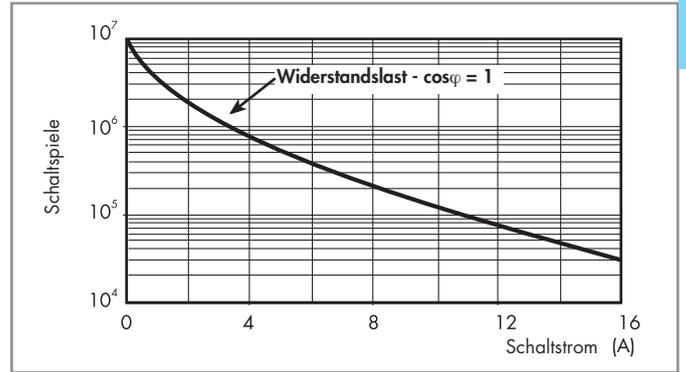
H 45 - Gleichstromschaltvermögen bei DC1 - Belastung
