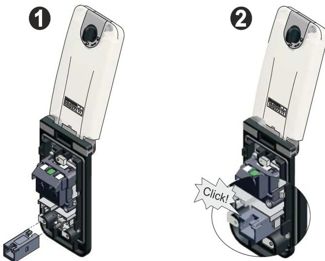
Abb. 4-2: Montage RJ45 und USB, Zusammenstellung beispielhaft
