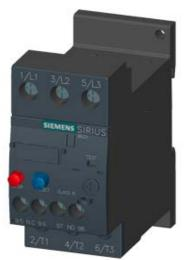
OVERLOAD RELAY 30...36 A FOR MOTOR PROTECTION SZ S0, CLASS 10, STAND-ALONE INSTALLATION MAIN CIRCUIT: SCREW TERMINAL AUX. CIRCUIT: SCREW TERMINAL MANUAL-AUTOMATIC-RESET
