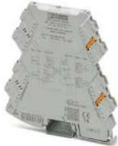
2-kanaliger eingangsschleifengespeister 2-Wege-Trenner mit steckbarer Anschluss-technik zur galvanischen Trennung von Analogsignalen. Eingangssignal = Ausgangssignal: 0(4) mA ... 20 mA. Push-in-Anschluss-technik.
