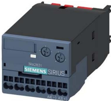
Elektronisches Zeitrelais, ansprechverzögert, mit Halbleiterausgang, Zeitbereich 0,05-100 s, AC/DC 90-240 V, 50/60 Hz, Varistor zur Bedämpfung der Schützspulen integriert, Federzuganschluss, frontseitig aufschraubbar auf Schütze 3RT2.3 / 3RT2.4
