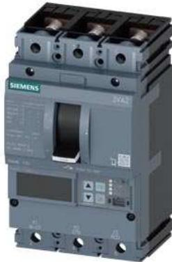
Leistungsschalter 3VA2 IEC Frame 100 Schaltvermögenklasse L Icu=150kA @ 415V 3-polig, Anlagenschutz ETU560, LSIG, In=100A Überlastschutz Ir=40A...100A Kurzschlusschutz Isd=0,6..10x In, li=1,5..12x In N-Leiterschutz optional mit externem Stromwandler, bis 160% Erdschlusschutz, abschaltbar Ig=0,2...1 x In, tg=0,05-0,8s Schraubenflachanschluss
