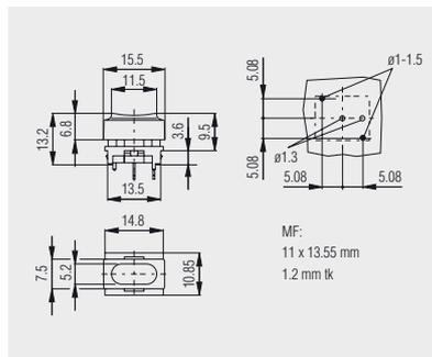
Schmale Taste mit integriertem Tastenkopf
