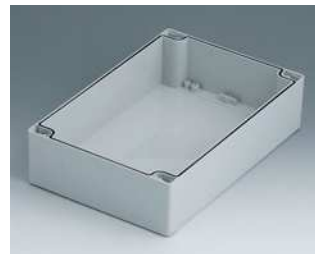
C3162401 Gehäuseschale 160, mit Dichtung ABS (UL 94 HB) lichtgrau RAL 7035 240x160x60mm
