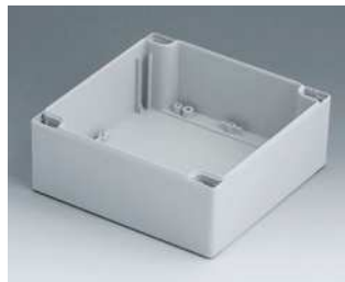
C2161602 Gehäuseschale 160, mit Feder PC (UL 94 HB) lichtgrau RAL 7035 160x160x60mm
