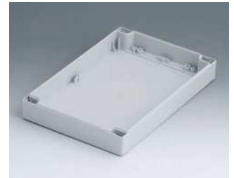
C0162402 Gehäuseschale 160, mit Feder PC (UL 94 HB) lichtgrau RAL 7035 240x160x30mm
