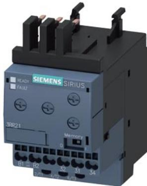
Überwachungsrelais, anbaubar an Schütz 3RT2, Baugröße S00 Basic, analog einstellbar Scheinstromüberwachung 1,6-16 A, 20-400 Hz, 2-phasig Versorgung 24 V AC/DC 1 Wechsler Überwachung auf Stromüber- und Unterschreitung Phasenausfall, Drahtbruch mit oder ohne Fehlerspeicher Anlaufverzögerung 0-60 s Störspitzenausblendung 0-30 s Schalthysterese 6% Federzugtechnik
