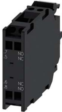
Kontaktmodul mit 2 Schaltgliedern, 1S voreilend+1Ö nacheilend, vergoldete Kontakte, Federzuganschluss, für Frontplattenbefestigung
