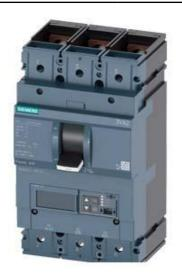
LEISTUNGSSCHALTER 3VA2 IEC FRAME 400 SCHALTVERMOEGENKLASSE H ICU=85KA @ 415 V 3-POLIG, ANLAGENSCHUTZ ETU850, LSI, IN=400A UEBERLASTSCHUTZ IR=160A ...400A KURZSCHLUSSSCHUTZ ISD=0,6... 10 X IN, II=1,5 X IN N-LEITERSCHUTZ OPTIONAL MIT EXT. CT, BIS 160% SCHRAUBENFLACHANSCHLUSS SPANNUNGSAUSLOESER (STL) 110-127 V DC, AC 50/60 HZ 2 HILFSSCHALTER HQ 1 AUSGELOEST-MELDESCHALTER HQ
