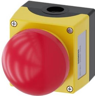
Gehäuse für Befehlsgeräte, 22 mm, rund, Gehäusematerial Kunststoff, Gehäuseoberteil gelb, 1 Befehlsstelle Kunststoff, Befehlsstelle mittig, A=NOT-HALT-Grobhandtaster, rot, Zwangsläufige Verrastung, Zugentriegelung, 1Ö, 1S, Schraubanschluss, Bodenbefestigung
