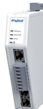
Konfigurationsschnittstelle verhindert. Wenn Ihre Konfiguration abgeschlossen ist, schieben Sie den Sicherheitsschalter einfach in die Verriegelungsposition. Anschließend leuchtet die Vorhängeschloss-LED am Communicator auf.
