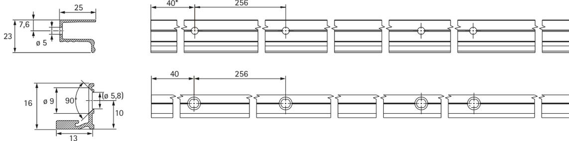
\* Bei Lochabstand > 40 mm wird der Einsatz einer Profilabstützung empfohlen.
