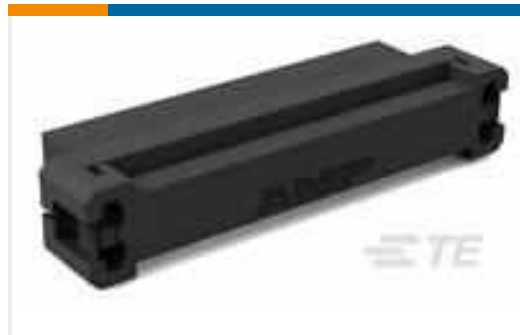
TE Teilnr.:1-111623-9 14, 2MM, POL,30 DP, LEAD FREE
