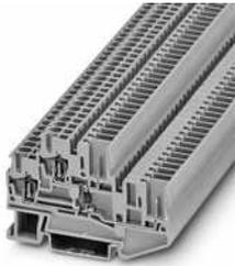
Bauelementreihenklemme, Strom und Spannung werden durch das eingesetzte Bauelement bestimmt., mit integrierter Diode, Nennspannung: 500 V, Nennstrom: 0,5 A, Anschlussart: Zugfeder- / Steckanschluss, 1. und 2. Etage, Querschnitt: 0,08 mm<sup>2</sup> - 4 mm<sup>2</sup>, Montageart: NS 35/15, NS 35/7,5, Farbe: grau
