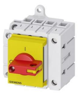
Lasttrennschalter 3LD3, lu 16 A Hauptschalter 3-polig + N Bemessungsbetriebsleistung bei AC-23 A bei 400V 7,5kW Verteilereinbau Basisschalter mit Knebelantrieb rot/gelb mit Hilfsschalter 10E+1S
