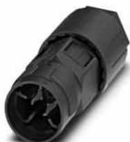
QUICKON Leitungsverbinder, mit einer QUICKON-Mutter, schwarz, 4+PE-polig, 2,5 mm<sup>2</sup> ... 6,0 mm<sup>2</sup> / 690 V / 40 A, für Kabeldurchmesser 12 mm ... 20 mm.
