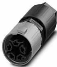
Steckverbinder, QUICKON-Anschluss, Polzahl: 4+PE, 2,5 mm<sup>2</sup> ... 6 mm<sup>2</sup>, 690 V, 40 A, schwarz, mit QUICKON-Mutter, Leitungsaußendurchmesser: 12 mm ... 20 mm
