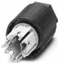
QUICKON-Mutter, schwarz, 4+PE-polig, 2,5 mm<sup>2</sup> ... 6,0 mm<sup>2</sup> / 690 V / 40 A, für Leitungen mit Durchmesser 12 mm ... 20 mm.
