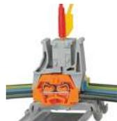
Die Prüfsteckerleisten lassen sich zum Prüfvorgang – auch bei angeschlossenen Leitern – auf die Klemmenleiste aufsnappen. Da die Kontaktierung per Tippkontakt an den CAGE CLAMP®-Anschluss aus Federstahl erfolgt, bleibt diese Prüfmethode auf einen Nennstrom bis maximal 0,5 A beschränkt.
