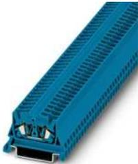
Minidurchgangsklemme, Nennspannung: 800 V, Nennstrom: 24 A, Anschlussart: Zugfederanschluss, 1. Etage, Bemessungsquerschnitt: 2,5 mm<sup>2</sup>, Querschnitt: 0,08 mm<sup>2</sup> - 4 mm<sup>2</sup>, Montageart: NS 35/7,5, NS 35/15, Farbe: blau
