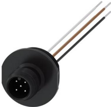
Zubehör für Positionsschalter Gerätestecker (5-polig), M12, für M20 x 1,5 für 125 V, 4 A auf Pin 5 eine gelb/grüne Leitung für PE
