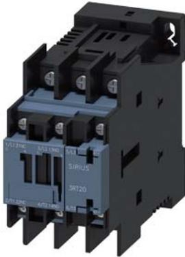
Bahnschütz, AC-3 12 A, 5,5 kW / 400 V 1 S + 1 Ö mit elektronischem Antrieb DC 24 V, 0,7-1,25\* US mit Varistor integriert 3-polig, Baugröße S0 Ringkabelschuhanschluss
