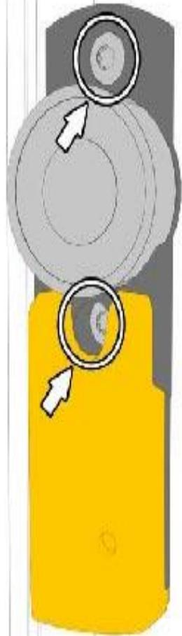
Abb.4: Prozesszuhaltung auf gewünschter Höhe am Profil anbringen und Schrauben M6 x 25 mm Torx festziehen.
