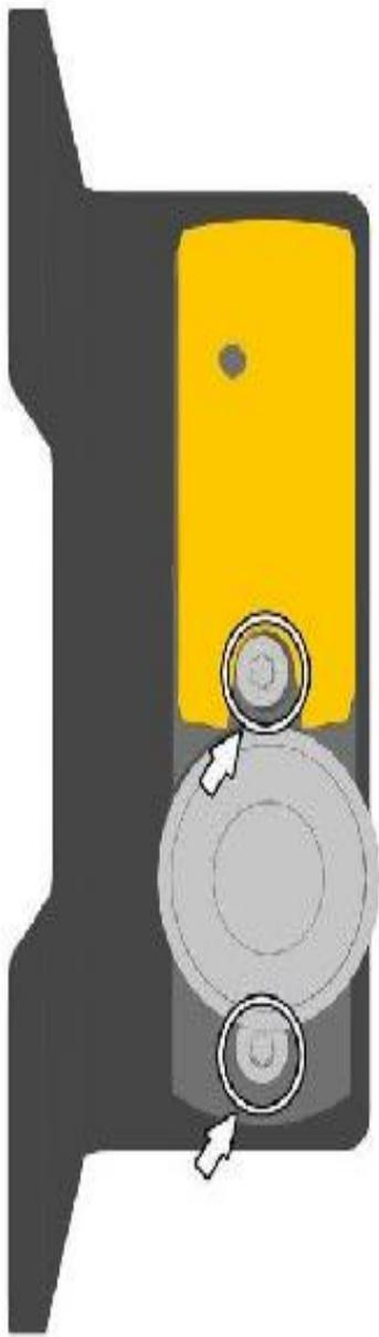
Abb.7: Prozesszuhaltung auf Montageplatte anbringen und Schrauben M6 x 25 mm Torx festziehen.
