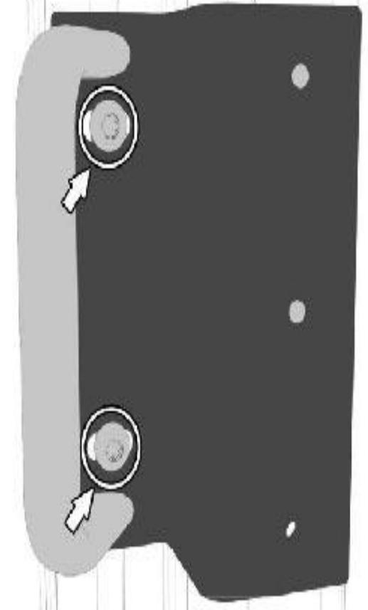
Abb.6: Montageplatte mit Ankerplatte am Profil anbringen und zur Prozesszuhaltung ausrichten. Schrauben M8 x 12 mm Torx festziehen.
