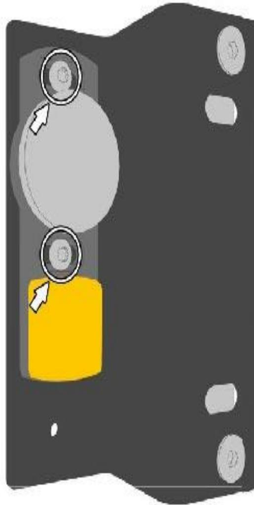
Abb.5: Ankerplatte an Montageplatte anbringen und Schrauben M6 x 8 mm Torx festziehen.
