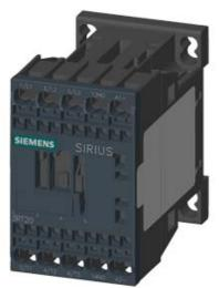
CONTACTOR, AC-3, 3KW/400V, 1NO, DC 125V, 3-POLE, SZ S00 SPRING-LOADED TERMINAL
