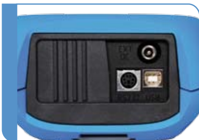
Kommunikation über USB und RS232 Schnittstelle.
