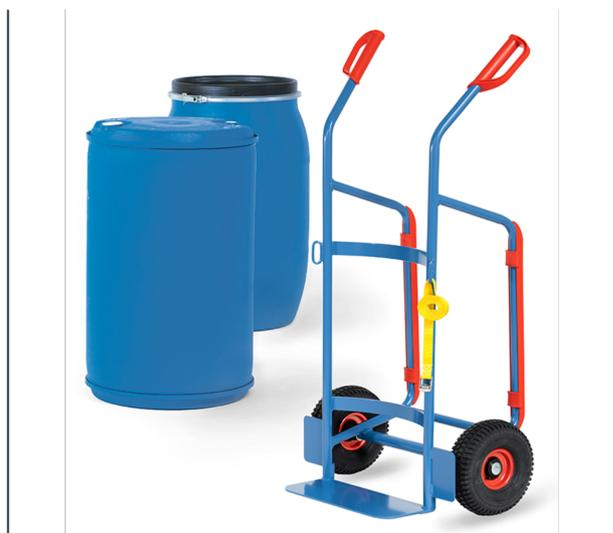
Ensemble mécano-soudé, revêtement époxy bleu RAL 5007. Diabie compatible pour fûts en plastique de 120-220 litres. Sangle sécurisant la charge. Roues gonflables, moyeu à roulement à rouleaux. Hauteur : 1300 mm ; Largeur : 640 mm.
