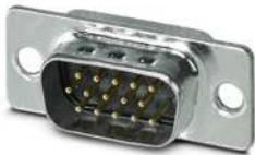
D-SUB-Kontakteinsatz, Shell-Größe 1, mit 15 Signalkontakten, Kontaktart Stift, mit Lötkehl, gerade, Befestigung mittels Bohrung 3 mm, für Anbaurahmen VS-09-...
