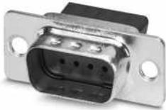
D-SUB-Kontaktträger, Shell-Größe 1, für 9 Signalkontakte, Kontaktart Stift, für Crimpkontakte, gerade, Befestigung mittels Bohrung 3 mm, für Anbaurahmen und Tüllengehäuse VS-09-...
