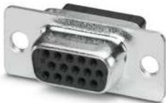
D-SUB-Kontaktträger, Shell-Größe 1, für 15 Signalkontakte, Kontaktart Buchse, für Crimpkontakte, gerade, Befestigung mittels Bohrung 3 mm, für Anbaurahmen und Tüllengehäuse VS-09-...
