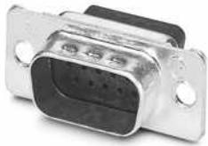
D-SUB-Kontaktträger, Shell-Größe 1, für 15 Signalkontakte, Kontaktart Stift, für Crimpkontakte, gerade, Befestigung mittels Bohrung 3 mm, für Anbaurahmen und Tüllengehäuse VS-09-...
