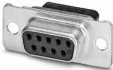
D-SUB-Kontaktträger, Shell-Größe 1, für 9 Signalkontakte, Kontaktart Buchse, für Crimpkontakte, gerade, Befestigung mittels Bohrung 3 mm, für Anbaurahmen und Tüllengehäuse VS-09-...
