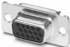
D-SUB-Kontakteinsatz, Shell-Größe 1, mit 15 Signalkontakten, Kontaktart Buchse, mit Lötkehl, gerade, Befestigung mittels Bohrung 3 mm, für Anbaurahmen VS-09-...
