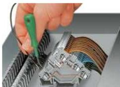
CAGE CLAMP®-Anschluss Leiter mit abgewinkeltm Betätigungswerkzeug (210-658) anschließen.
