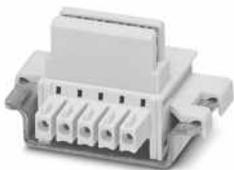
Tragschienen-Busverbinder, Farbe: lichtgrau, Nennstrom: 8 A, 8 A (parallele Kontakte) (serielle Kontakte), Bemessungsspannung (III/2): 50 V, Polzahl: 5, Rastermaß: 3,81 mm, Montage: Tragschienenmontage, Verriegelung: ohne, Befestigungsart: ohne, Verpackungsart: verpackt im Karton, Artikel mit vergoldeten Kontakten, Busstecker zur Verbindung mit Elektronikgehäusen, 4 Parallelkontakte/1 serieller Kontakt
