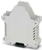
Tragschienengehäuse, Gehäuseunterteil mit Metallfußriegel, hohe Bauform, mit Lüftungsschlitzen, Breite: 35,2 mm, Höhe: 99 mm, Tiefe: 107,3 mm, Farbe: lichtgrau (7035), Querverbindung: Tragschienen-Busverbinder (optional), Polzahl Querverbinder: 5
