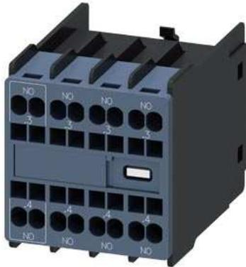
Hilfsschalter, elektronikgerecht, frontseitig, 4 S, .3/4, .3/4, .3/4, .3/4, Strombahn: 1 S (elektronikgerecht), 1 S, 1 S, 1 S, Federzuganschluss, für Schütze 3RT2
