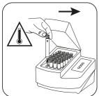
Küvette aus dem Thermoreaktor nehmen. (Achtung: abkühlen lassen. Küvette ist heiß!)
