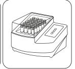
Küvette(n) in vorgeheiztem Thermoreaktor für 120 Minuten bei 150 °C aufschließen.
