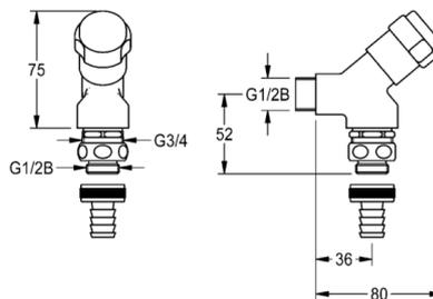
Geräteanschlussventil DN 15, für Wandmontage, mit Dreikantgriff, Rückflussverhinderer, Rohrbelüfter, Schlauchverschraubung und Kopfstück G 3/4 x G 1/2 B.
